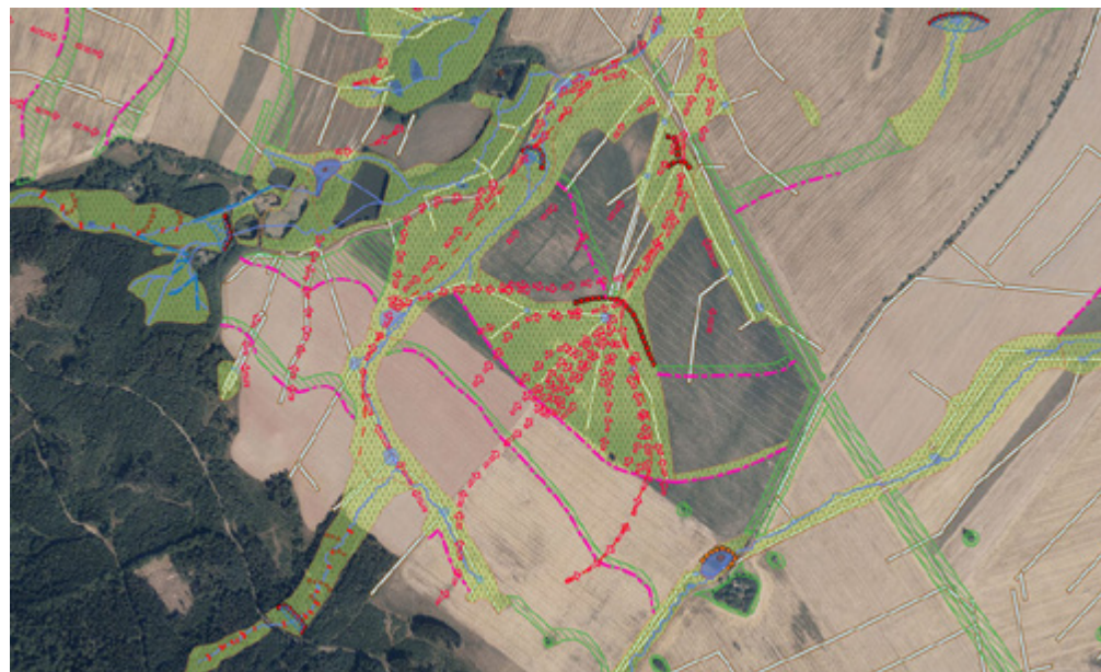
Výsledek mapování krajiny a plán opatření – červeně eroze, bíle meliorace, zeleně návrhy konturových výsadeb a modře návrhy tůň a mokřadů
