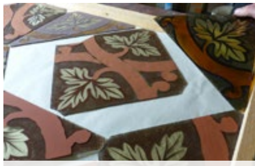
Vitrážistické barvy jsou nejprve hnědé, při vypéčení se zataví do skla a zprůhlední
